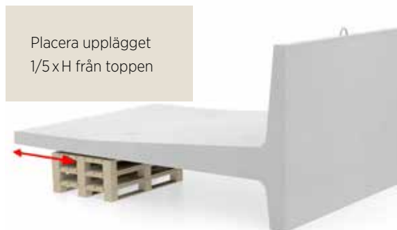
Fig 3.2 Placering av pallar under T-stödmur
