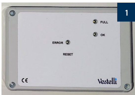
Bild 1: Högnivåalarmets inre enhet för sluten tank.
